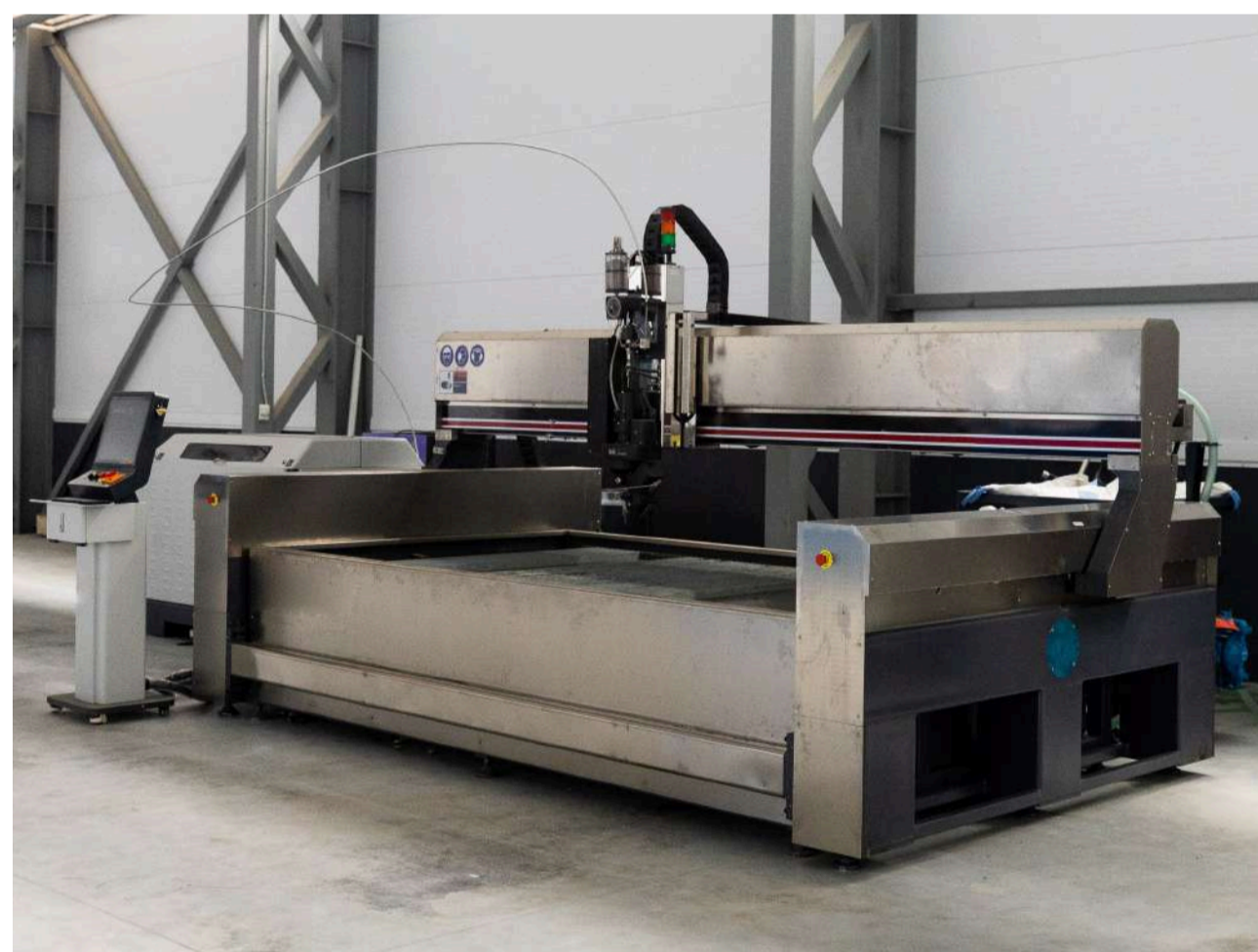
Установка гидроабразивной резки
